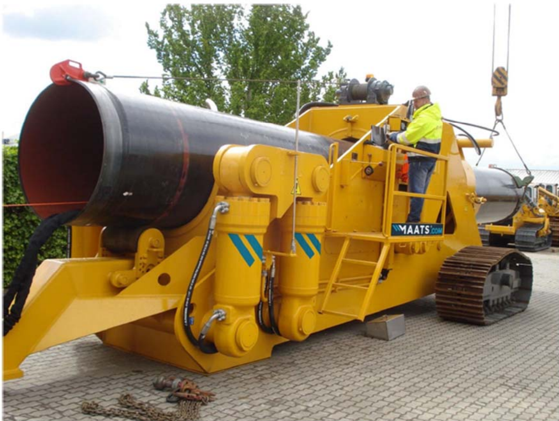
Фигура 12. Направа на студено огънати колена с тръбогиб (pipe bending machine)
