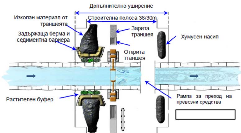
Фигура 19. Директен метод на изкопаване
